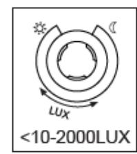
Le détecteur de crépuscule peut être réglé sur 10LUX – lumière de jour. Tourner le bouton dans le sens antihoraire pour régler la valeur LUX la plus basse de 10 lux. Tournez le cadran complètement dans le sens des aiguilles d'une montre pour régler la valeur de lumière du jour la plus élevée du LUX.
