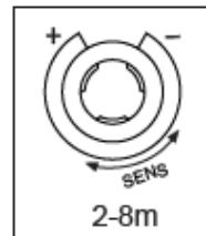
La plage de détection peut être modifiée par le contrôleur. Tournez le bouton dans le sens inverse des aiguilles d'une montre pour réduire la zone de détection. La zone de détection minimale est de 1 m. Tournez le cadran dans le sens des aiguilles d'une montre pour augmenter la plage de détection. La plage de détection maximale est comprise entre 6 et 8 m.
