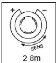
Der Erfassungsbereich kann durch den Regler verändert werden. Drehen Sie den Regler im Gegenuhrzeigersinn, um den Erfassungsbereich zu verkleinern, der minimale Erfassungsbereich ist 1m. Drehen Sie den Regler im Uhrzeigersinn, um den Erfassungsbereich zu vergrößern, der maximale Erfassungsbereich ist 6-8m.
