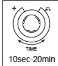
Ce réglage permet de fixer la durée pendant laquelle la lumière sera allumée après la dernière détection. Tournez le cadran dans le sens antihoraire pour raccourcir le temps de dépassement. La durée minimale de suivi (contrôle à l'extrême droite) doit être réglée sur 6 secondes. Tournez le bouton dans le sens des aiguilles d'une montre pour augmenter le temps de dépassement. Le temps maximum de suivi (à gauche du contrôleur) est de 12 minutes.
