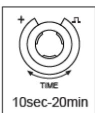
Mit dem Zeitregler kann die Nachlaufzeit des Lichtes nach der letzten Bewegung im Erfassungsberich eingestellt werden. Drehen Sie den Regler im Gegenuhrzeigersinn, um die Nachlaufzeit zu verkürzen. Die minimale Nachlaufzeit (Regler ganz rechts) ist 6 Sekunden einzustellen. Drehen Sie den Regler im Uhrzeigersinn, um die Nachlaufzeit zu verlängern. Die maximale Nachlaufzeit (Regler ganz links) ist 12 Minuten.
