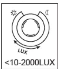
Der Dämmerungssensor kann auf 10LUX – Tageslicht eingestellt werden. Drehen Sie den Regler voll im Gegenuhrzeigersinn, um den niedrigsten LUX Wert von 10LUX einzustellen. Drehen Sie den Regler im Uhrzeigersinn, um den höchsten LUX Wert von Tageslicht einzustellen.
