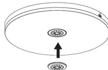
4 Linsenclips. Ausbrechen der Vorhangssektoren für die Selektion der Erfassungsbereiche.
