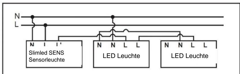
**ACHTUNG:** schliessen Sie bei SlimLED Sens (mit Melder) max. 6 SlimLED ohne Melder an. Abb.8. SlimLED Vernetzung ohne Kabel: Benutzen Sie das Modell SlimLED Sens BITEC (Funk 2.4 GHz) für die drahtlose Vernetzung von mehr als 6 resp. 8 Leuchten.
